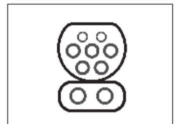
**Der CCS-Stecker ergänzt den Typ 2-Stecker mit zwei zusätzlichen Leistungskontakten um eine Schnellladefunktion und unterstützt AC- und DC-Laden.**
