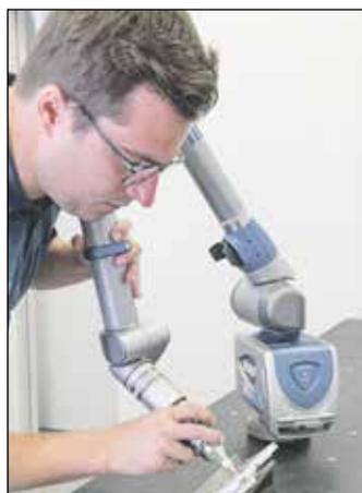
**Bauteilüberprüfung mittels Messarm im Hundertstel-mm-Bereich**
