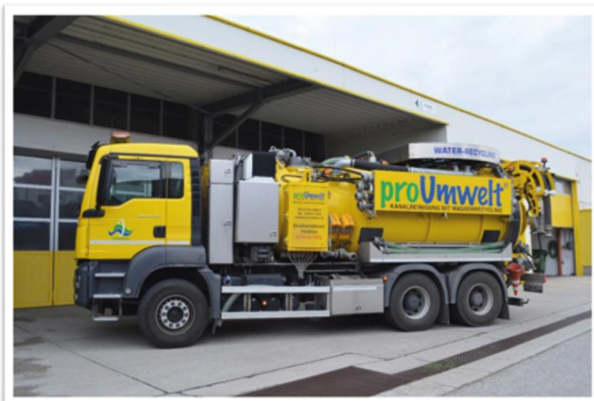
Mit unserem modernen KAISER Recycling-Kanalkombi werden die Kanäle sauber und zugleich schonend gereinigt, ohne dabei wertvolles Trinkwasser zu verschwenden. Das moderne Wasser-Recycling-System erlaubt es, die Reinigungsarbeiten mit Abwasser aus dem Kanal durchzuführen, welches im Fahrzeug vorgereinigt wird. Wir entsorgen häusliche Abwässer in die regionalen Kläranlagen. Weiteres reinigen wir Öl- und Fettabscheideranlagen und Sandfänge in Betrieben.
